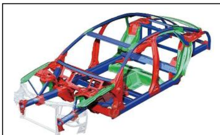
图1 通过增减合金元素的配比和采用适当的热处理工艺使车身各部位具有不同的强度和韧度，以保护车厢内乘员的安全
