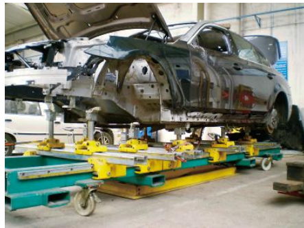
图8 使用SPANESI带定位夹具的大梁校正仪校正全铝质宝马车身
