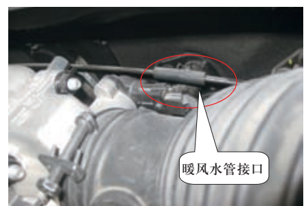
图19 暖风水管接口
