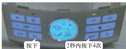
图21 现代悦动自动空调自诊断操作
