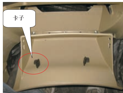
图12 杂物箱卡子的拆卸
