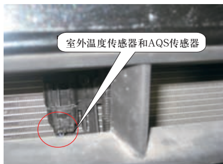
图20 室外温度传感器安装位置
