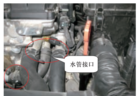
图18冷却系水管接口
