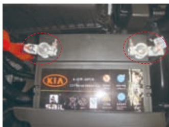
图7 电瓶正、负极端子与接线未拧紧
