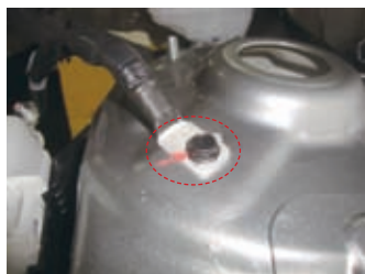
图8 电瓶接地线未拧紧
