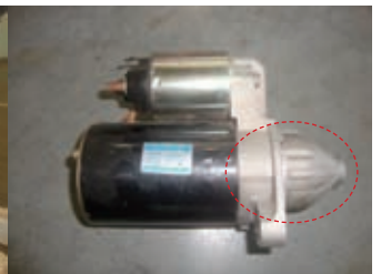
图9 汽缸瓢板安装口偏心
