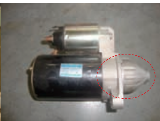
图9 汽缸瓢板安装口偏心
