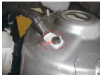
图8 电瓶接地线未拧紧
