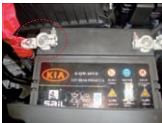
图5 电瓶正极端子接触不良
