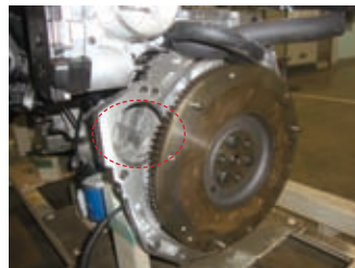
图9 汽缸瓢板安装口偏心
