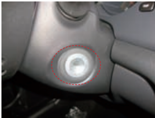
图3 锁芯开关断线及接触不良
