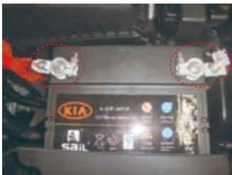
图7 电瓶正、负极端子与接线未拧紧
