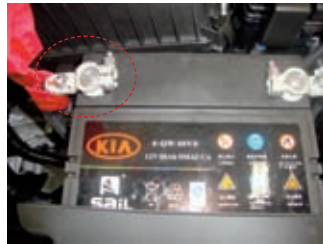
图5 电瓶正极端子接触不良
