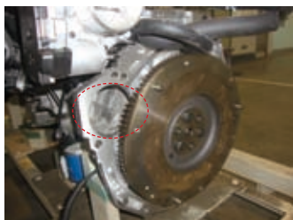
图9 汽缸瓢板安装口偏心
