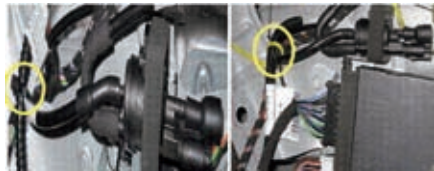
图3 故障部位处理前后的对比
