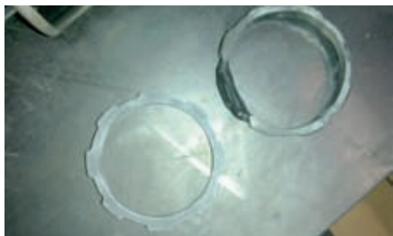
图13 新旧导向胶环的对比
