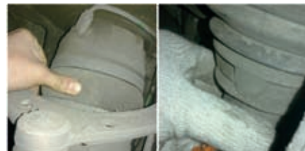
图10 对空气弹簧进行泄漏和储存压力检测
