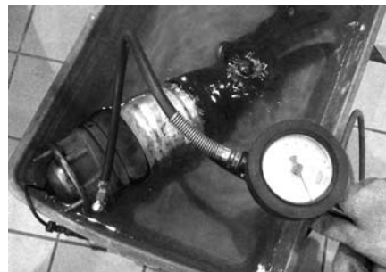
图11 对空气弹簧进行泄漏检测
