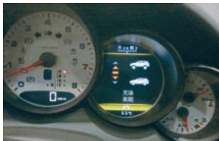
图8 多功能仪表出现“无法实现”的报警提示
