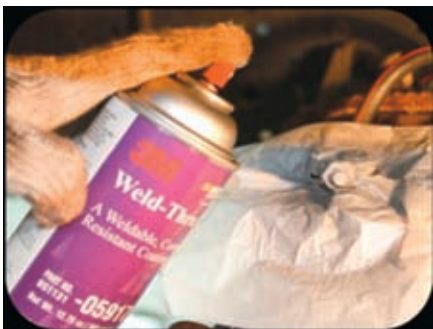
图7 距离喷涂面50mm左右进行喷涂
