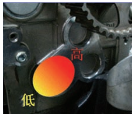
图4 导致涨紧轮不平的缸盖位置
