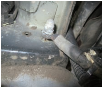
图1 腐蚀的搭铁点
