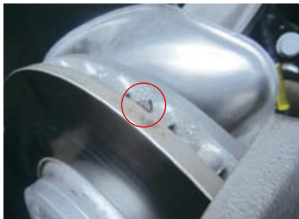
图2 刹车盘通风孔中有异物
