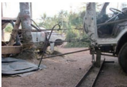
图1 通过大树固定的手拉葫芦
