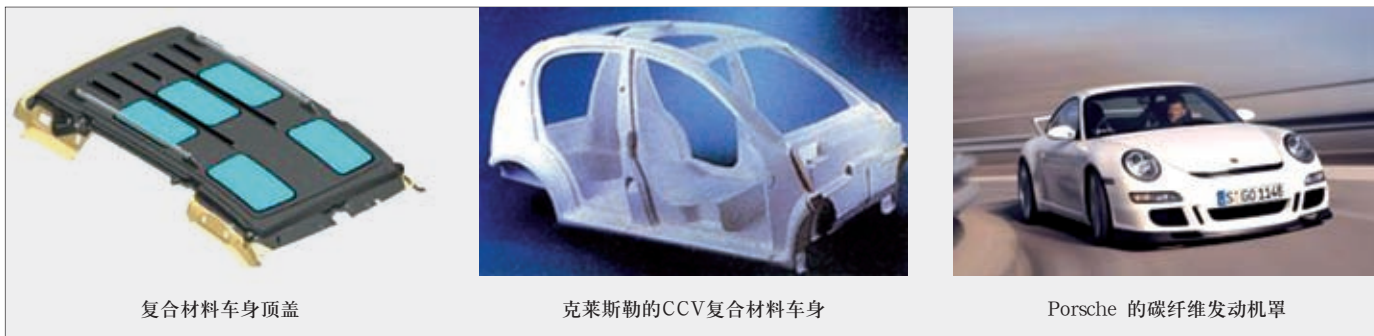
图2 复合材料在车身上的应用
