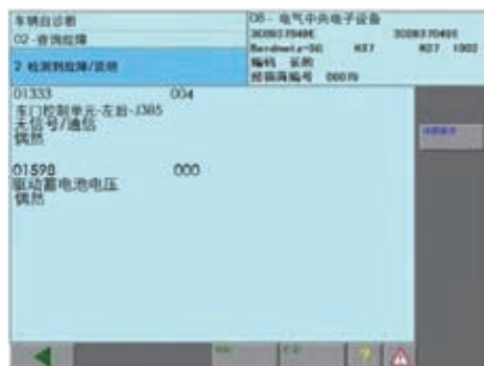
图1 空调控制单元故障显示
