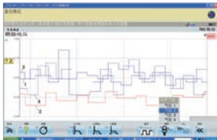
图2 次级点火电压燃烧波形
