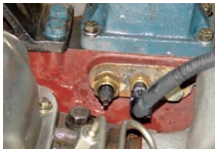
图20 冷却水温度感应器实机安装
