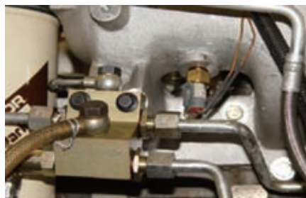
图17 进气温度感应器实机安装
