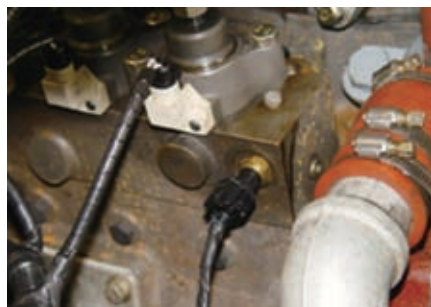
图19 燃油温度感应器实机安装
