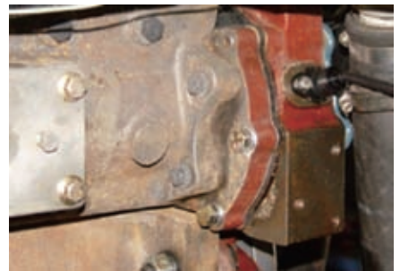
图12 凸轮轴转速感应器实机安装
