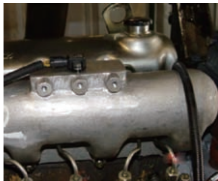
图15 增压压力感应器实机安装
