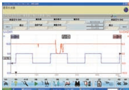
图2 异常的凸轮轴位置传感器波形
