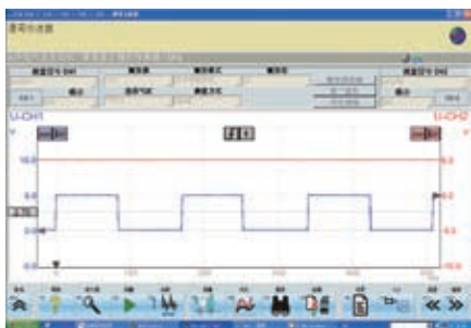
图1 凸轮轴位置传感器G40信号波形
