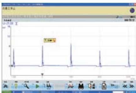
图3 故障时的次级并列波形
