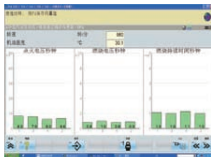
图5 故障时的全适配波形
