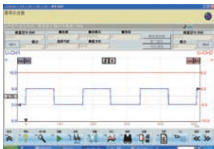
图1 凸轮轴位置传感器G40信号波形
