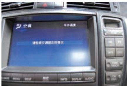
图1 空调故障时界面显示
