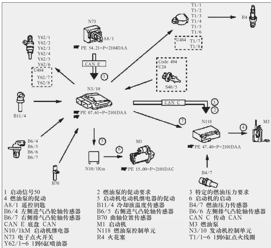
图1 发动机启动过程的功能原理图
