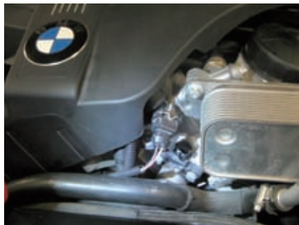
图5 拔下水温传感器插头
