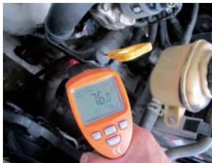
图6 使用红外线测温仪测量温度
