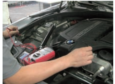
图7 发动机至负极的电压降测量
