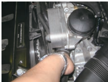
图4 用手感觉上下水管温度、软硬、脉动感情况
