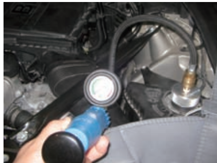
图8 冷却系统压力测量
