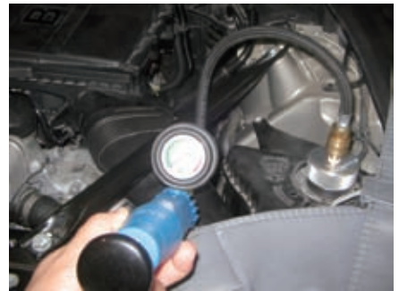
图8 冷却系统压力测量
