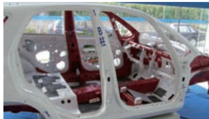
图4 汽车车身侧面结构
