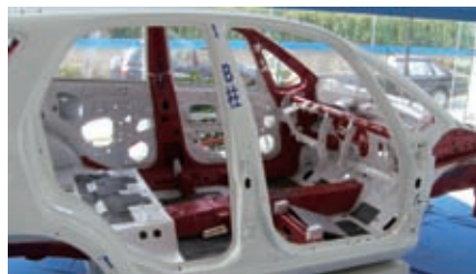
图4 汽车车身侧面结构
