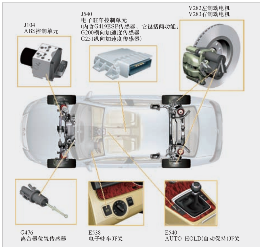
图4 电子驻车制动整体布置图(以迈腾为例)
