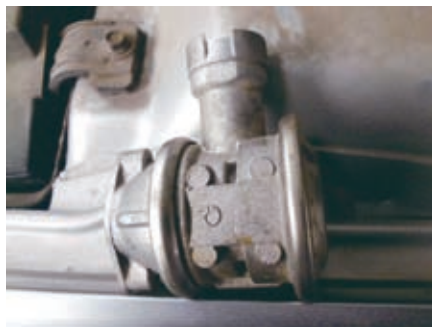
图3 损坏的二次空气组合阀
