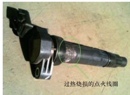
图7 过热烧损的点火线圈
