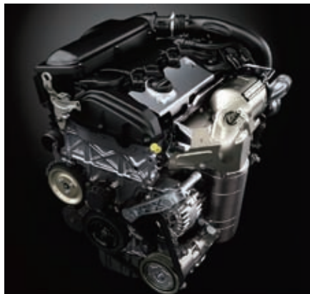
图2 DS4和DS5配备的THP155型发动机
