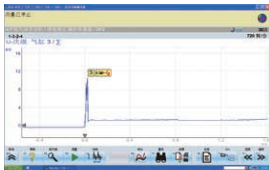
图3 异常的第3缸次级点火波形
