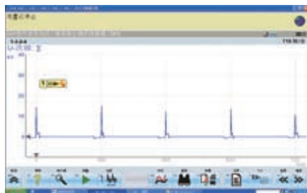
图10 正常时的次级点火平行波形
