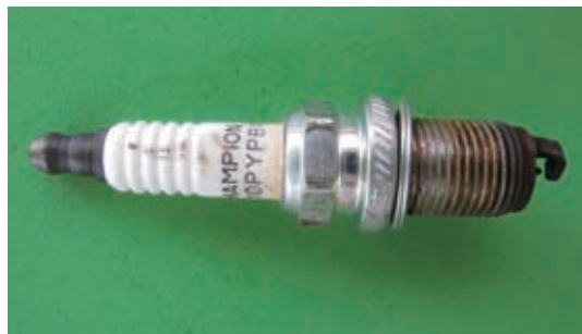
图5 出现漏电闪络的3缸火花塞
