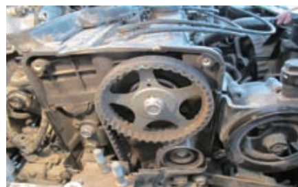
图8 凸轮轴正时记号错齿
