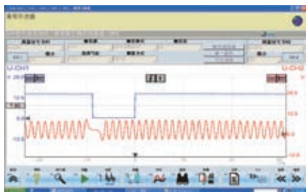
图9 正确的曲轴与凸轮轴位置传感器对比波形
