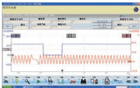
图1 凸轮轴与曲轴位置传感器波形
