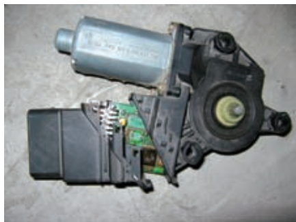
图1 损坏的控制模块总成
