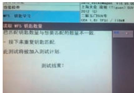
图3 匹配不成功时的诊断仪显示界面
