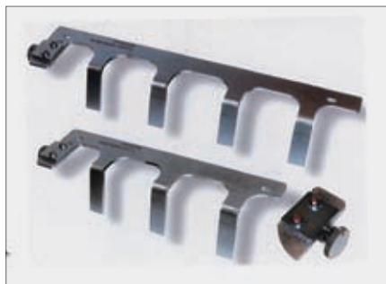
图6-26 安装泵喷嘴单元用的调准量规
