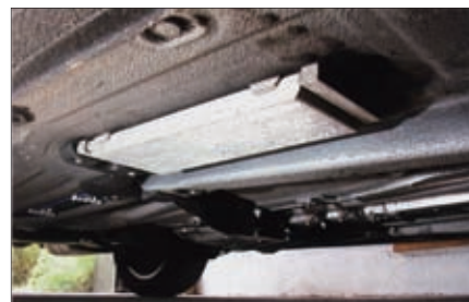
图6-23 汽车地板下的燃油冷却器
