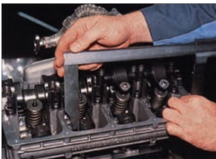
图6-25 测量x尺寸检查泵喷嘴单元安装的准确性
