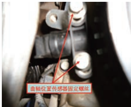
图4 松动的曲轴位置传感器固定螺丝
