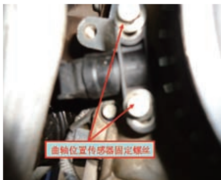
图4 松动的曲轴位置传感器固定螺丝
