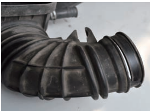
图4 进气软管已经破碎、裂口
