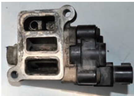
图5 怠速控制阀阀门上被厚厚的泥土包裹
