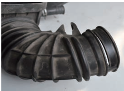
图4 进气软管已经破碎、裂口
