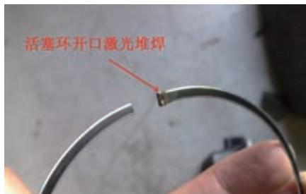
图6 活塞环激光堆焊
