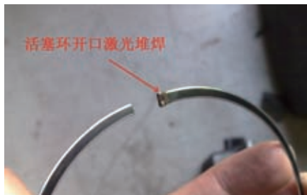
图6 活塞环激光堆焊
