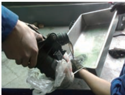
图8 中冷器腔内沉积大量机油
