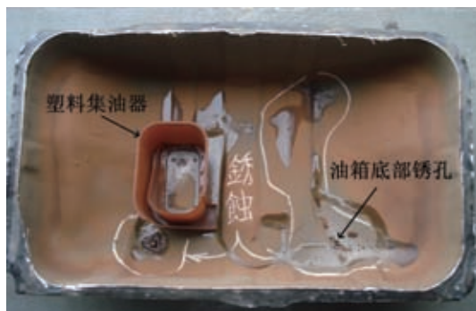
图1 油箱内腔底部已经锈蚀、穿孔
