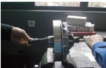
图5 使用专用工具将衬套安全无损拉出
