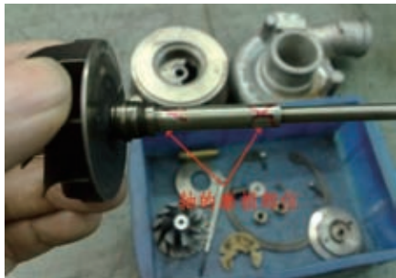
图9 轴的磨损部位
