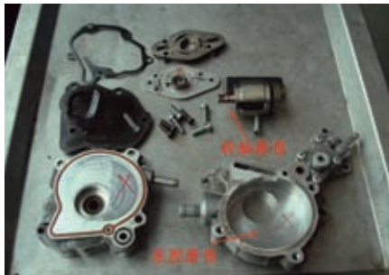
图11 转轴颈严重磨损
