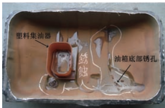
图1 油箱内腔底部已经锈蚀、穿孔
