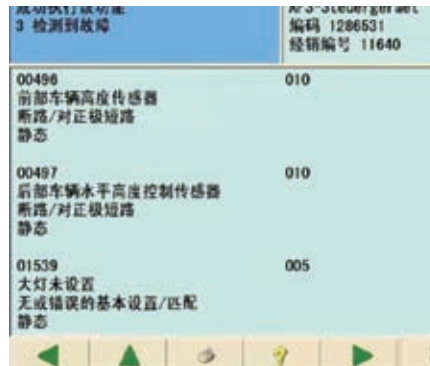
图3 用仪器读取故障码
