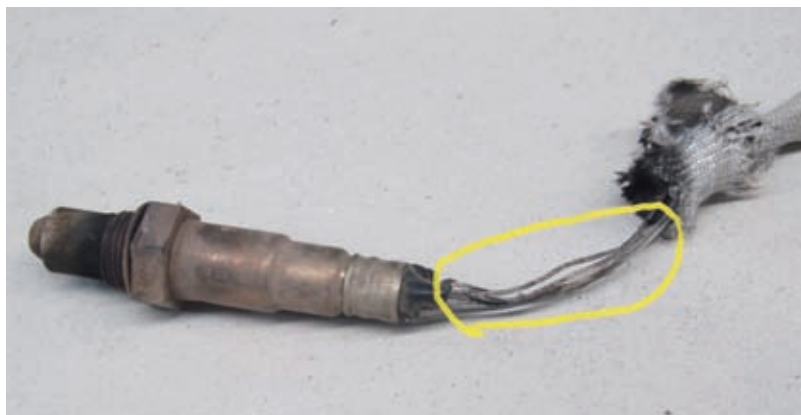
图2 后氧传感器导线粘连
