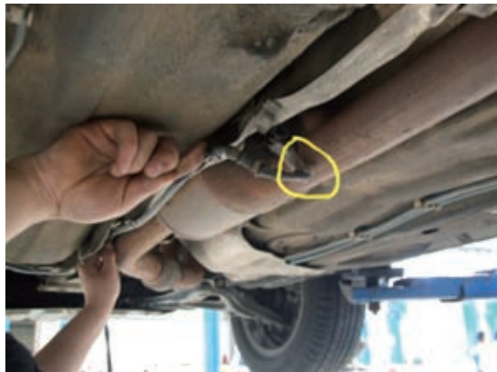
图1 后氧传感器线束搭在排气管上
