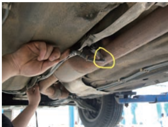
图1 后氧传感器线束搭在排气管上
