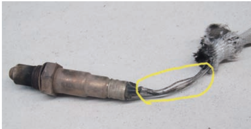
图2 后氧传感器导线粘连
