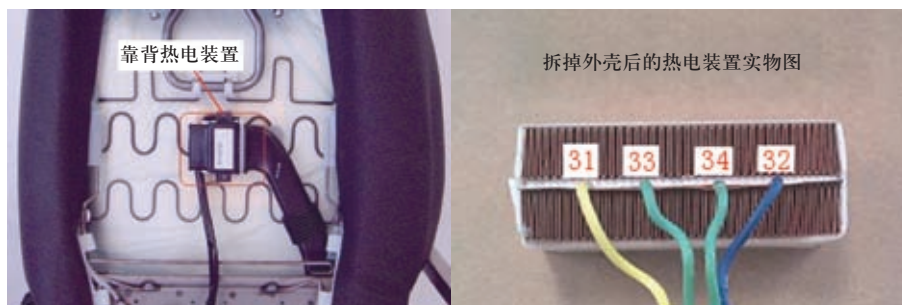
图4 安装在座椅靠背的热电装置
