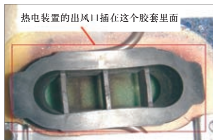
图7 出风口胶套已密封，冷气无法吹出
