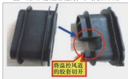
图8 将温控风道的胶套切开，防止气流被堵塞
