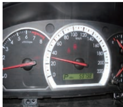
图2 怠速时车速为30km/h
