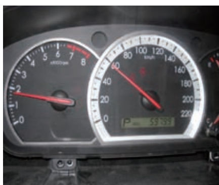
图5 原地加速1900r/min时车速为60km/h
