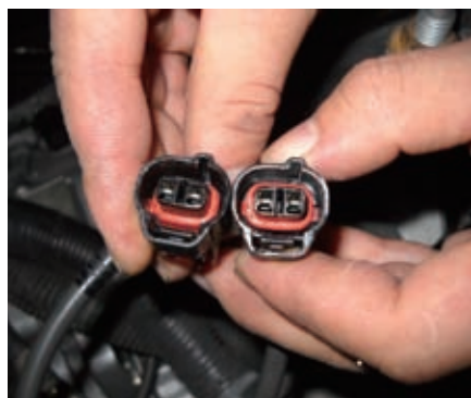
图4 变速器输入/输出传感器颜色不同
