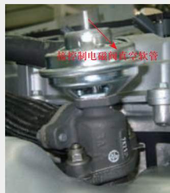
图4 真空控制型EGR控制阀
