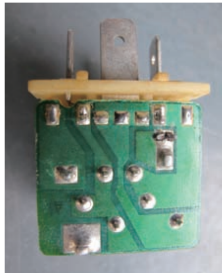
图2 主继电器焊点烧蚀
