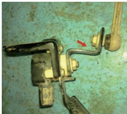
图2 变形的传感器支架
