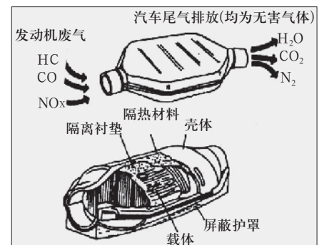
图7 三元催化装置的结构
