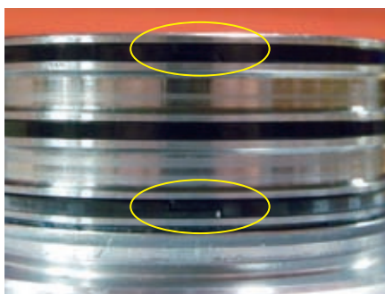
图1 相邻两个PEEK密封环接口要180° 错开
