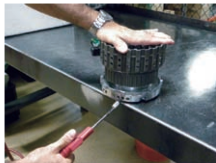
图4 用高压气枪对准相应的液压流道孔吹气
