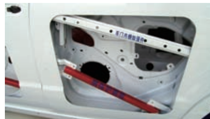
图8 汽车后门加强件
