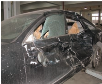
图11 汽车侧面严重碰撞损坏
