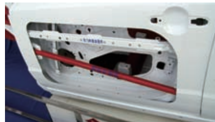
图9 汽车前门内板加强板
