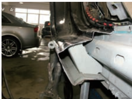
图5 车身门槛梁结构
