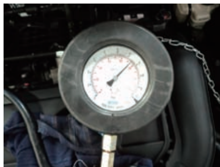
图3 发动机工作时的燃油压力
