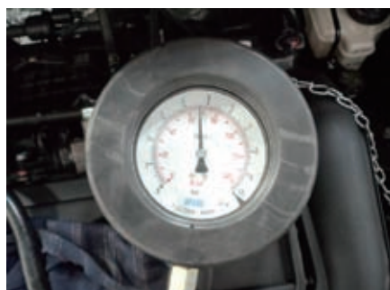
图4 发动机熄火10min后压力
