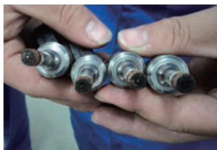
图5 喷油嘴的积炭
