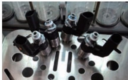
图6 超声波清洗喷油嘴
