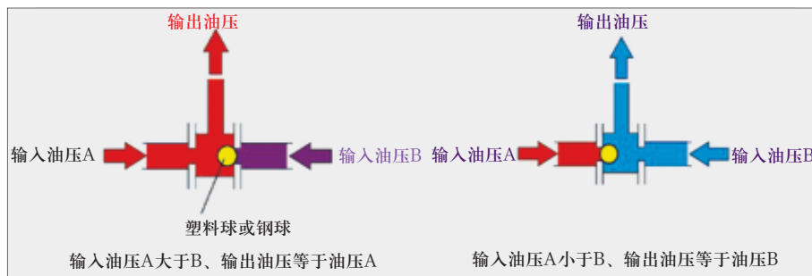
图3 阀体A处钢球的作用原理
