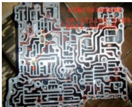
图1 阀体上A处和B处有磨损, 但没有钢球
