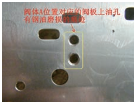
图2 阀体上A处对应的阀板上油孔有钢油磨损的痕迹
