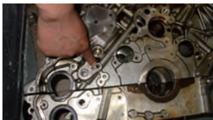
图2 更换下的旧缸体内置沉头螺钉的螺纹孔
