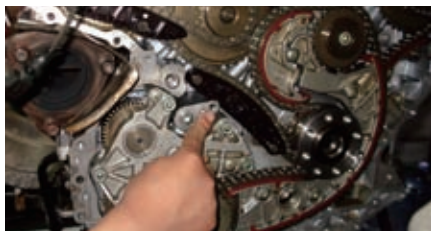
图1 故障车辆新缸体上未上螺栓的螺纹孔
