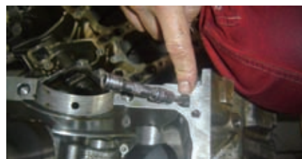
图3 汽缸体上没有堵上的机油油道加工孔
