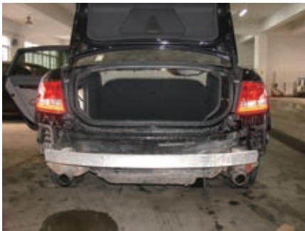
图10 奥迪车身后部横梁结构
