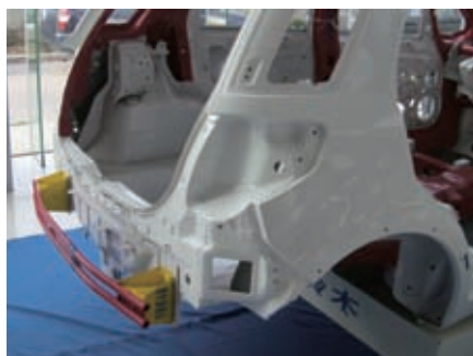
图6 车身后部防碰撞结构
