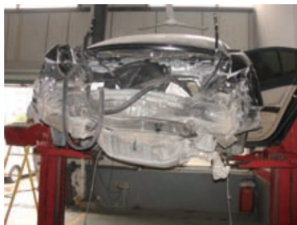
图13 车身后部碰撞严重损坏
