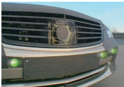
图7 雷达传感器安装位置
