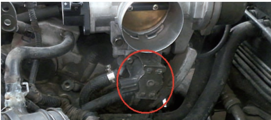
图6 对跛行阀线路进行检查
