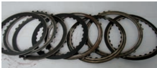
图1 烧损的摩擦片
