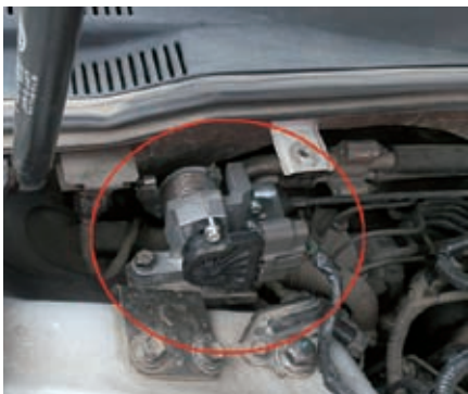
图5 全新的油门踏板位置传感器
