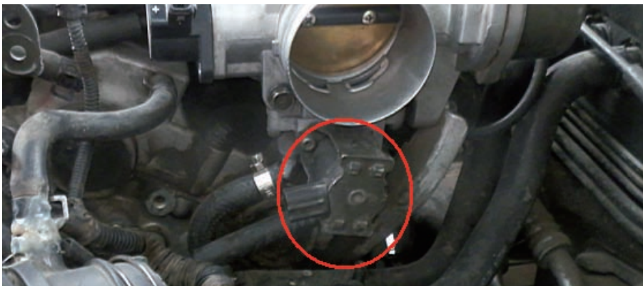
图6 对跛行阀线路进行检查
