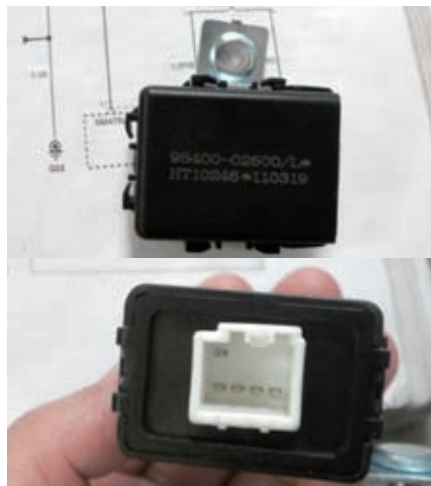
图1 点火具模块实物图
