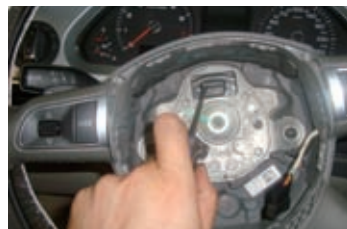
图2 用金属螺丝刀短接1号、2号端子
