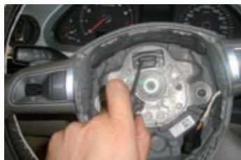
图2 用金属螺丝刀短接1号、2号端子
