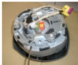
图3 断裂的钢丝线
