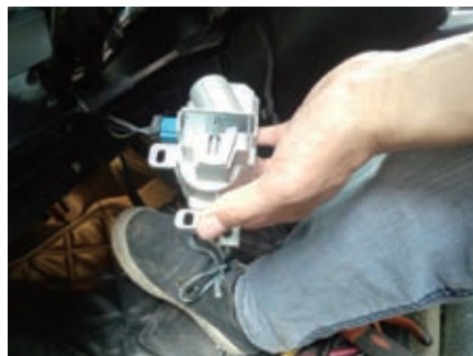
图2 转向柱锁销未弹出, 卡在解锁的位置
