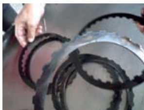
图3 发生锥形形变的离合器片
