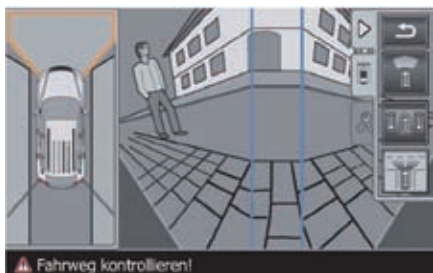
图23 通过区域全景系统观察左右两侧的情况
