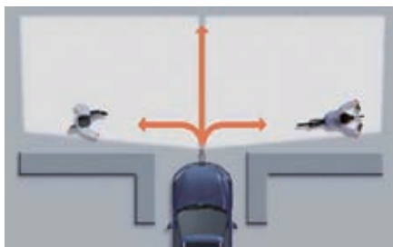
图22 全景系统的观察视野示意
