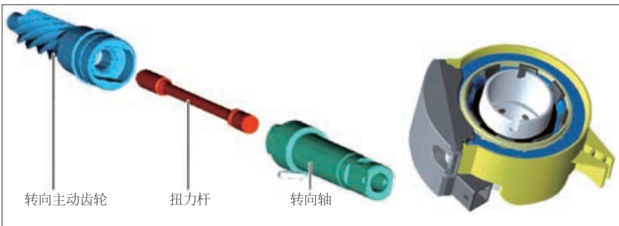
图6 转向力矩传感器G269结构图
